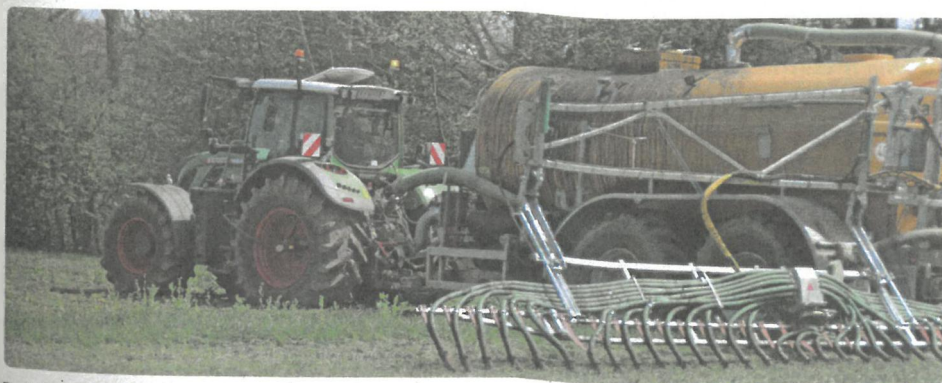
Bei der Gülleausbringung mittels Schleppschuh werden die Ammoniakemissionen um ca. 50 Prozent reduziert. | © BWSB
