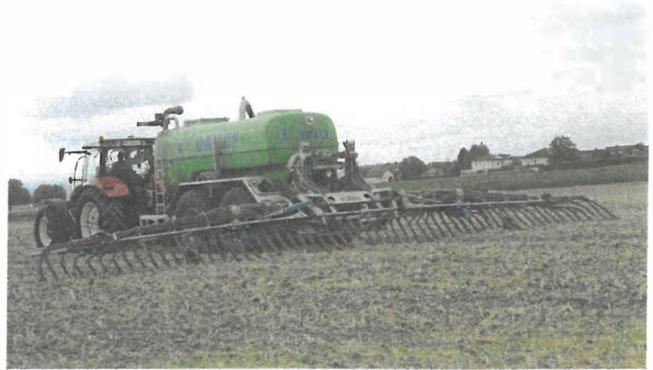
Abb. 4: Bei der Gülleausbringung mittels Schleppschuh werden die Ammoniakemissionen um ca. 50 Prozent reduziert.
