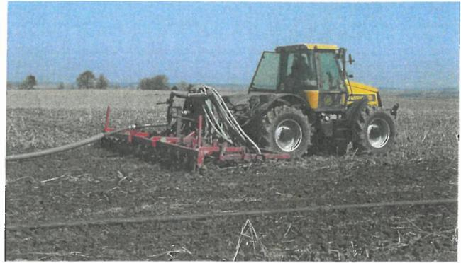
Abb. 6: Bei der Gülleausbringung mittels Gülleinjektion werden die Ammoniakemissionen um ca. 80 Prozent reduziert.
