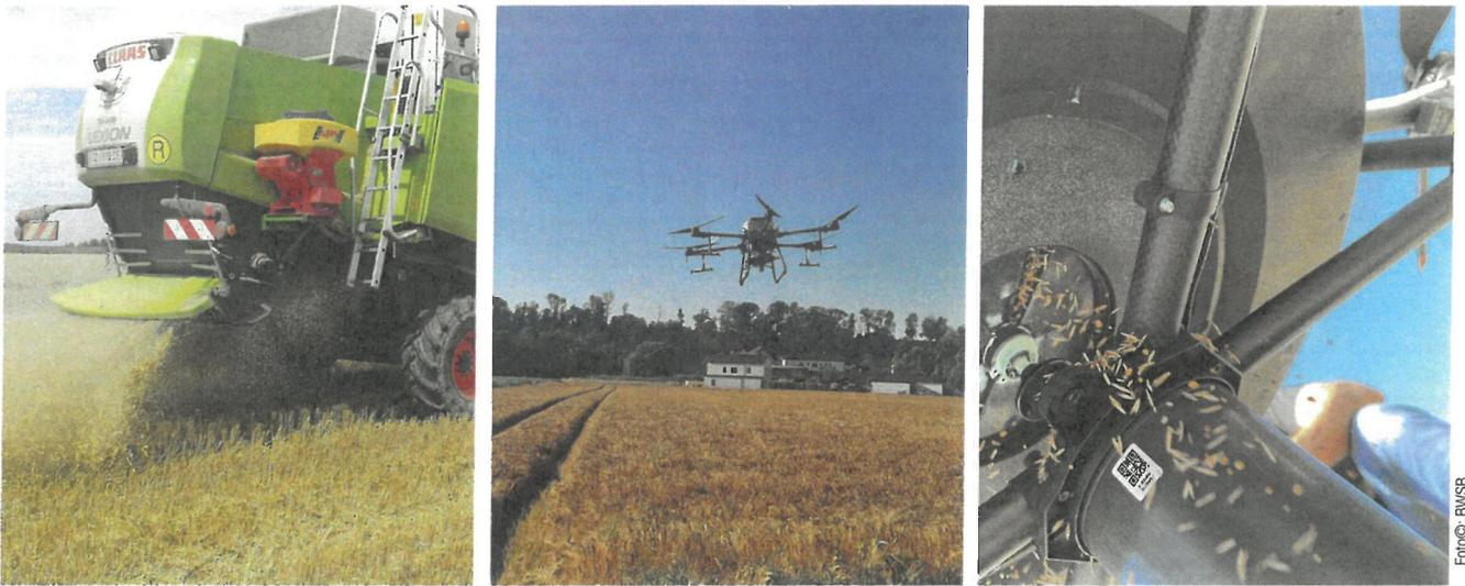
Abb. 5: Mähdruschsaat (links) und Drohnensaat (Mitte und rechts) ermöglichen sehr frühe Begrünungsanbautermine.
