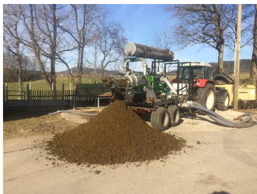
Gülleseparierung – Trennung von flüssiger und fester Phase
