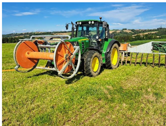
Gülleverschlauchung – bodenschonend durch minimales Gewicht
