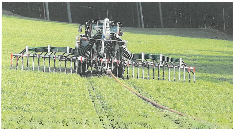
Gülleverschlauchung mit Schleppschuhtechnik ist bodenschonend und effizient.
