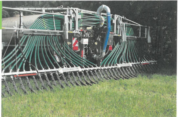
Am Grünland erfolgt die bodennahe streifenförmige Ausbringung von Gülle am häufigsten mittels Schleppschuhtechnik. BWSB/Hölzl
