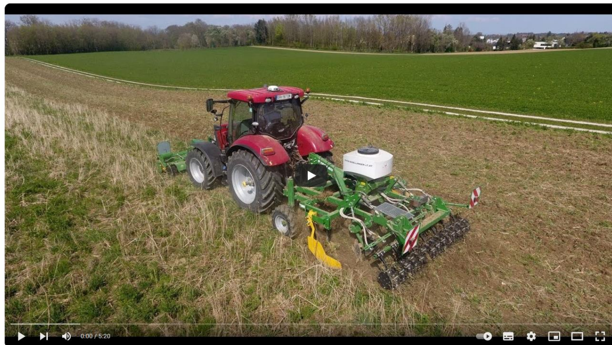
Gerätekombination für den Begrünungsumbruch
