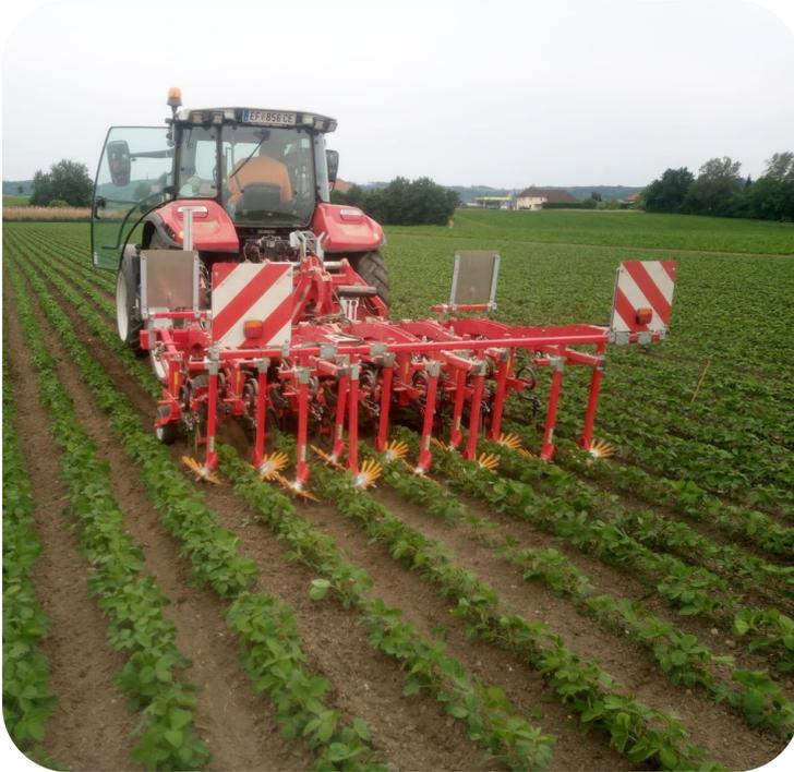
*Bild 4: Zweites Mal Hacken am 3. Juni: Hackgerät, Chopstar mit Kameralenkung und Fingerräder (Bild: LK OÖ/Seiter).*
