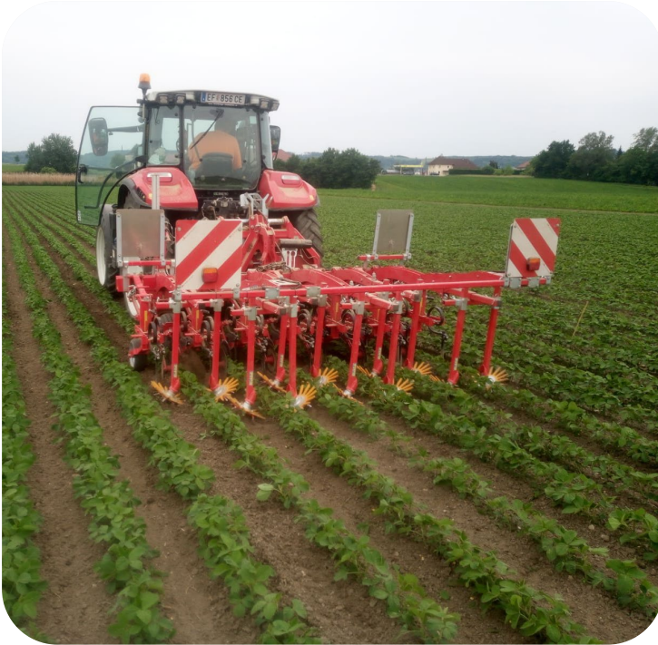
Bild 4: Zweites Mal Hacken am 3. Juni: Hackgerät, Chopstar mit Kameralenkung und Fingerräder (Bild: LK OÖ/Seiter).
