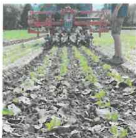
Kameragesteuerte Hackgeräte entfernen Unkräuter in der Reihe und minimieren Handarbeitsstunden. BWSB/Lehner
