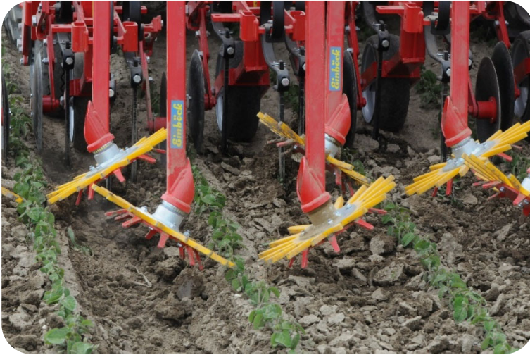
Bild 4: Hackgerät, Chopstar mit Kameralenkung und Fingerräder (Bild: LK OÖ/Seiter).
