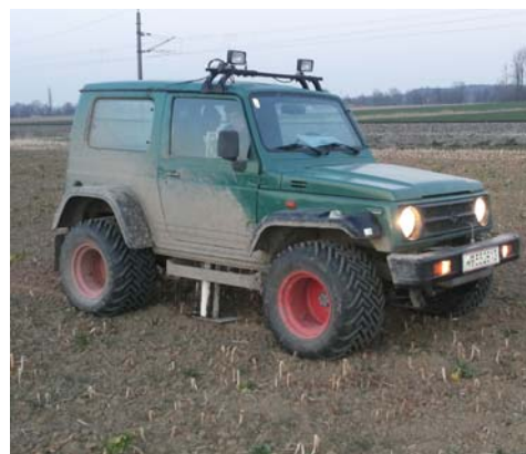
Bodenprobenziehung mit einem speziellen Bodenbohrer.
