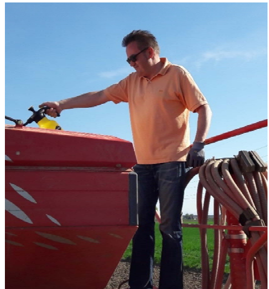
Vor jeder Anwendung eines neuen Impfmittels wurde die Sämaschine mit 70%igem Alkohol desinfiziert.
