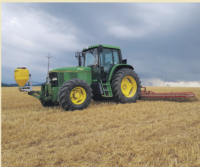
Ein normaler Hackstriegel wird für die Saat verwendet.
