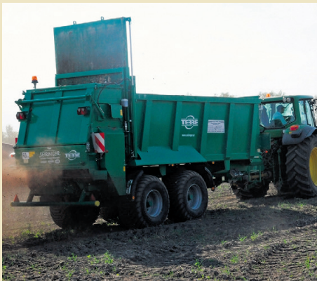
Ausbringtechnik: Bei der Kompostanwendung kommt es maßgeblich auf die Verteilgenauigkeit an. Kompoststreuer mit hydraulischem Kratzbodenvorschub sind heute Standard.
