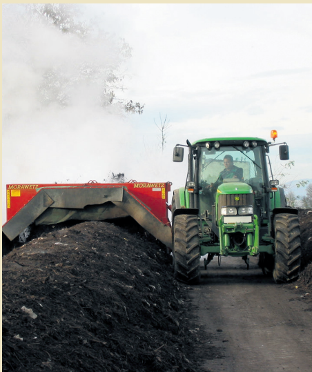
Offene Mietenkompostierung: In Österreich wird zum überwiegenden Teil in Form der offenen Mieten auf befestigter Fläche kompostiert. Das Umsetzen der Walm erfolgt mit einem traktorbetriebenen oder selbstfahrenden Kompostwender.
