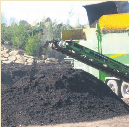
Gesiebte Komposte: Heute werden in der Landwirtschaft ausschließlich gesiebte Komposte ausgebracht, um unverrottete, verholzte Teile, Steine und andere Störstoffe vor der Ausbringung möglichst auszuschneiden.
