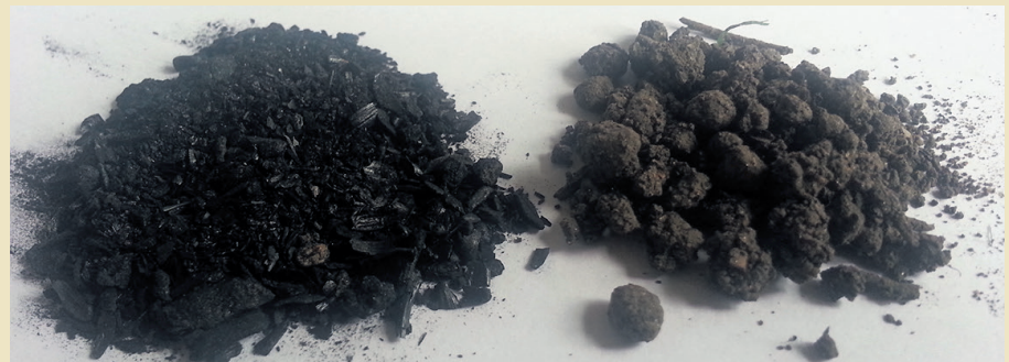
Pflanzkohle und Kompost. Links: Pflanzkohle (100 Prozent); Rechts: Pflanzkohle (13 Prozent) vermischt mit Kompost.
