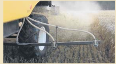
Am hinteren Mähdrescherteil wird das Sägestänge montiert.
